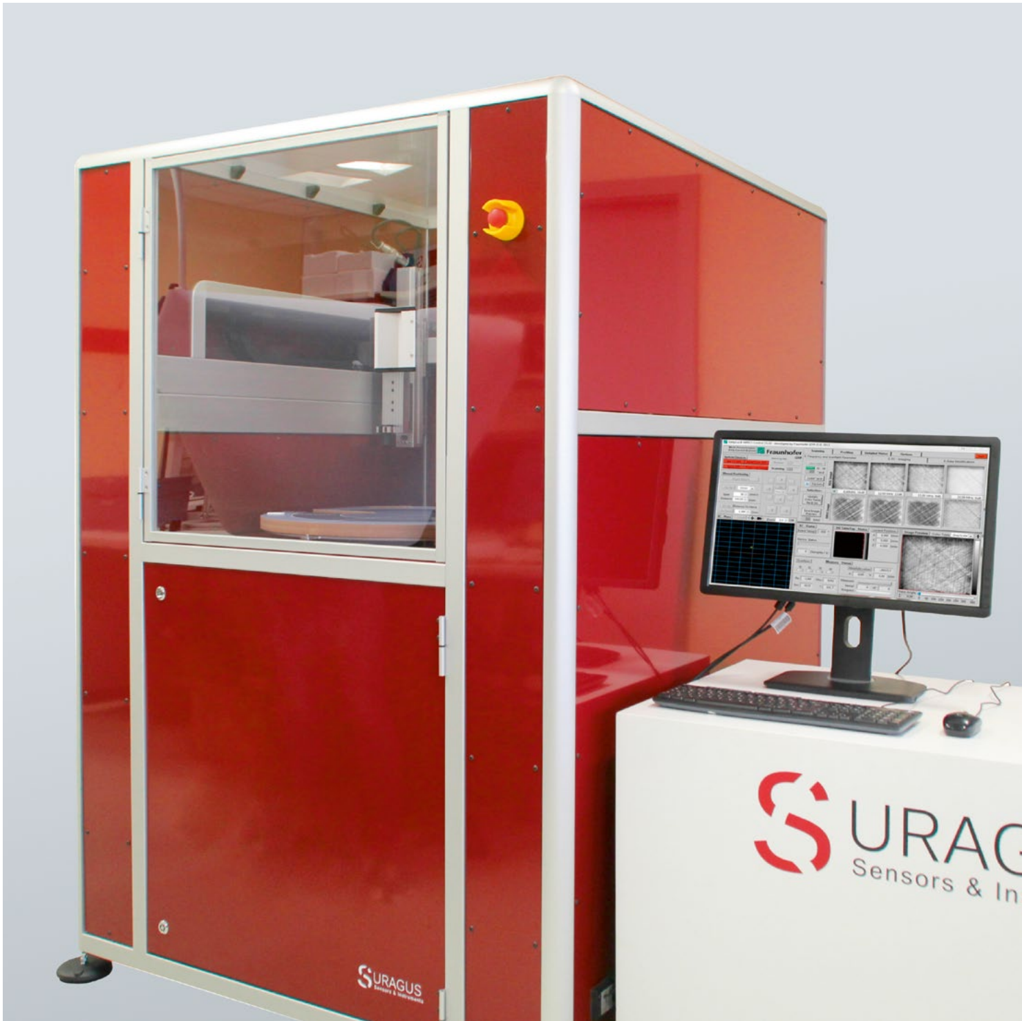
Der EddyCus® CF map erstellt EC-Scans mit einer Messgeschwindigkeit von 10 bis 400 mm/s. Die Auswertung der Scans erfolgt in Echtzeit.
