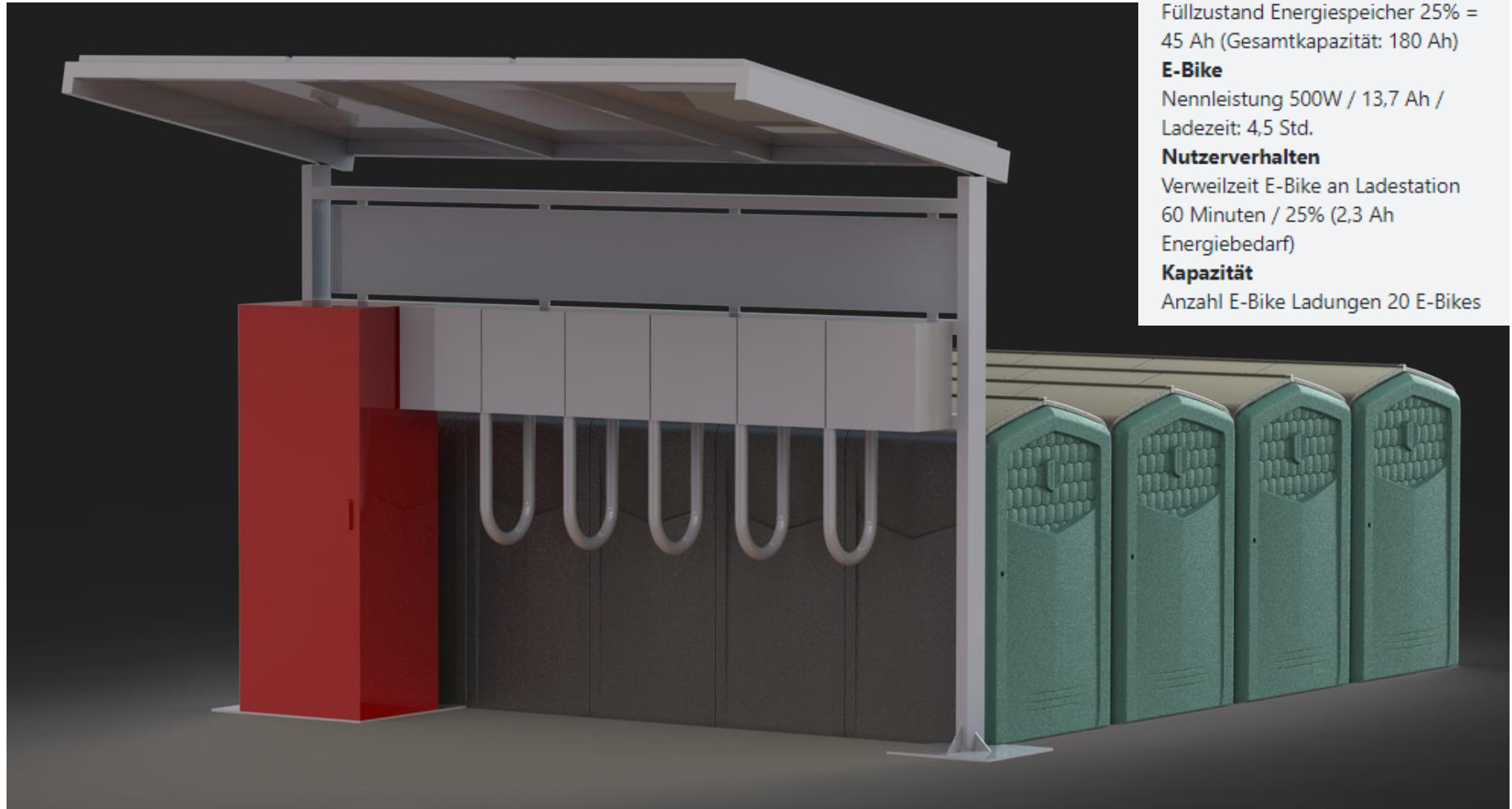
Ladestation mit Photovoltaik-Modulen mit Batteriespeicher
