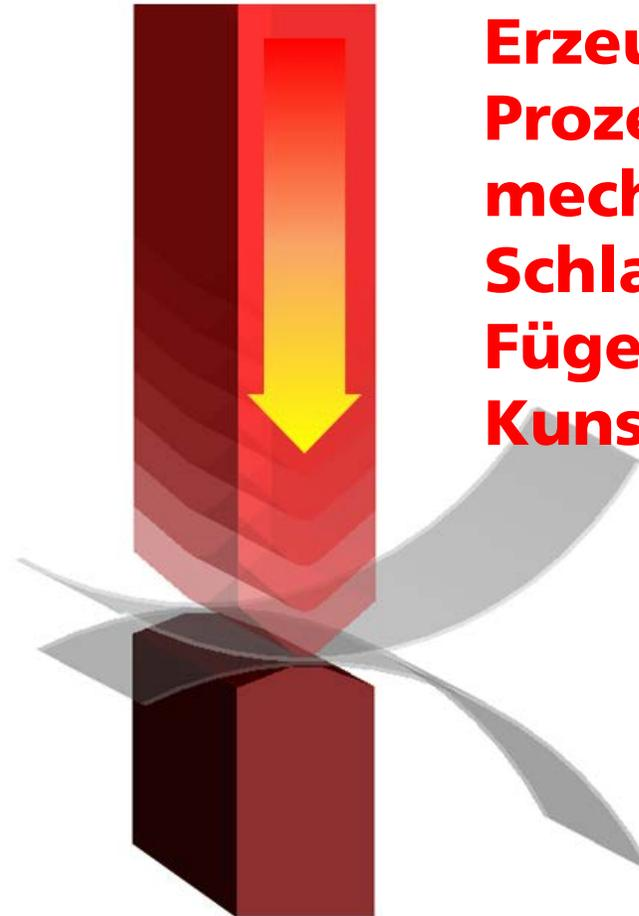
**Erzeugung von Prozesswärme durch einen mechanischen Schlagimpuls für das Fügen von Kunststofffolien**
